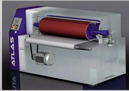
Das Entgratmodul steht an erster Stelle in der Linie, wenn die Teile gratbehaftet sind.
