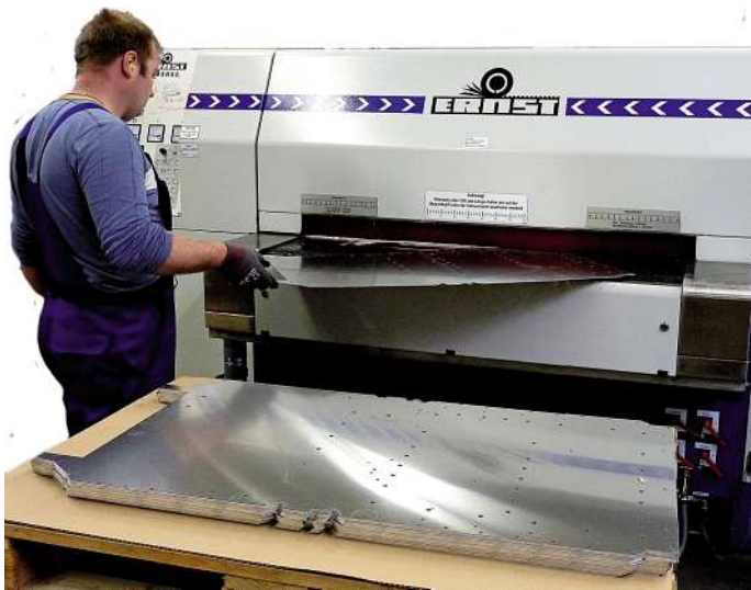
Jetzt wird das erste Teil der Ernst-Nassschleifmaschine EM 5 N II/L1400 zugeführt. Mit ihr beweist LTI auch seine Kompetenz in der Blechkantenbearbeitung.
