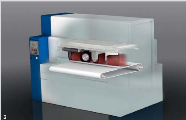
**1** Modulare Gesamtanlage »Neptun«. **2** Das Entgratmodul des Neptun-Baukastens entfernt Grate, ohne die Oberfläche zu schleifen. **3** Mit dem Modul »Spin« kann man Kanten stark und gleichmäßig verrunden. Es eignet sich für ebene und profilierte, auch folierte und verzinkte Werkstücke.
