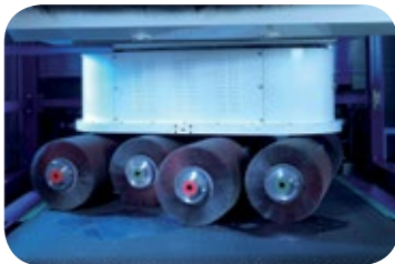
Rotationseinheit mit 8 gegenläufigen Bürsten
