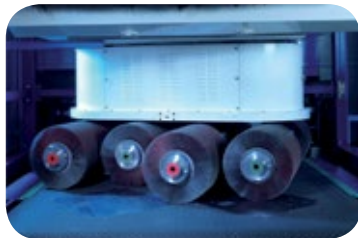
Rotationseinheit mit 8 gegenläufigen Bürsten
